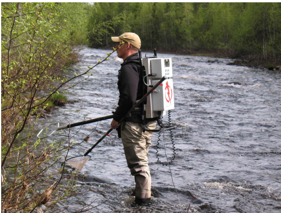
Utrustning vid elfiske elfiskestav, håv samt ett batteridrivet elfiskeaggregat
