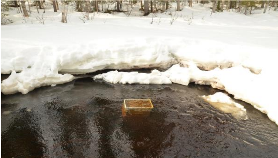
Figur 2. Visar en romback som placerats ut i ett vattendrag.
